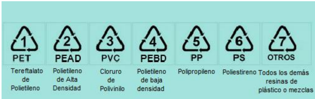
Fig. 1. Identificación de los plásticos. FUENTE: Norma IRAM 13700
