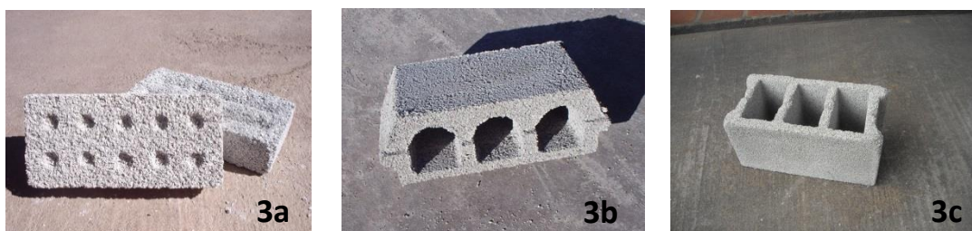
Fig. 3. Componentes fabricados con PET reciclado
