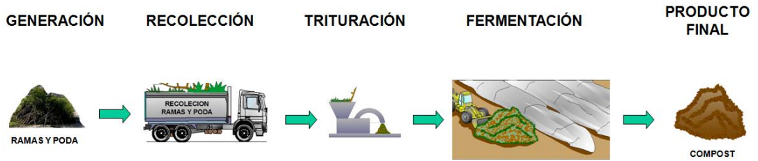
Fig.8. Esquema de la producción de compost
