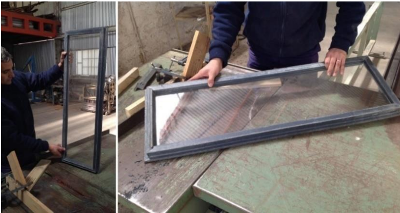
Fig. 16. Prototipo de marco de ventana de con perfiles de plástico reciclado
