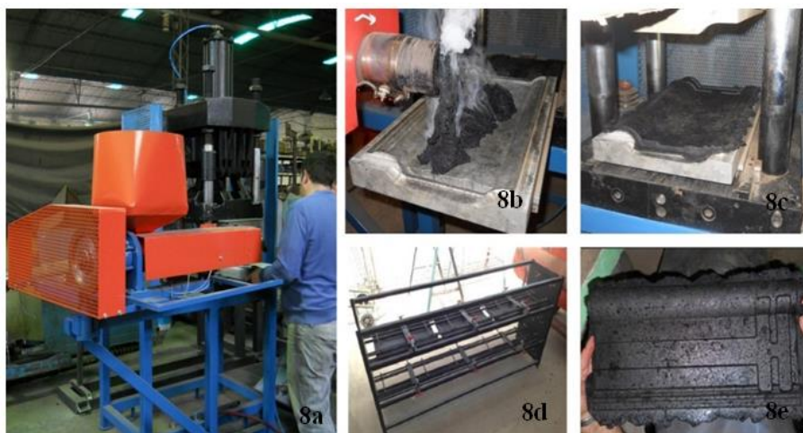
Fig. 8. Proceso de fabricación de tejas de caucho y plástico
