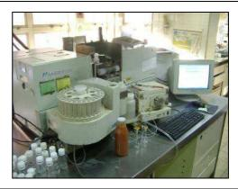
Foto Nº 56. Sodio: espectrofotometría de absorción atómica.
