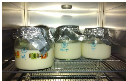
Incubación en estufa a (42±1)°C por 4 h
