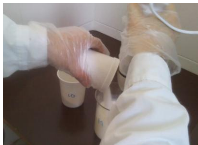
Agregado de aditivos a la premezcla
