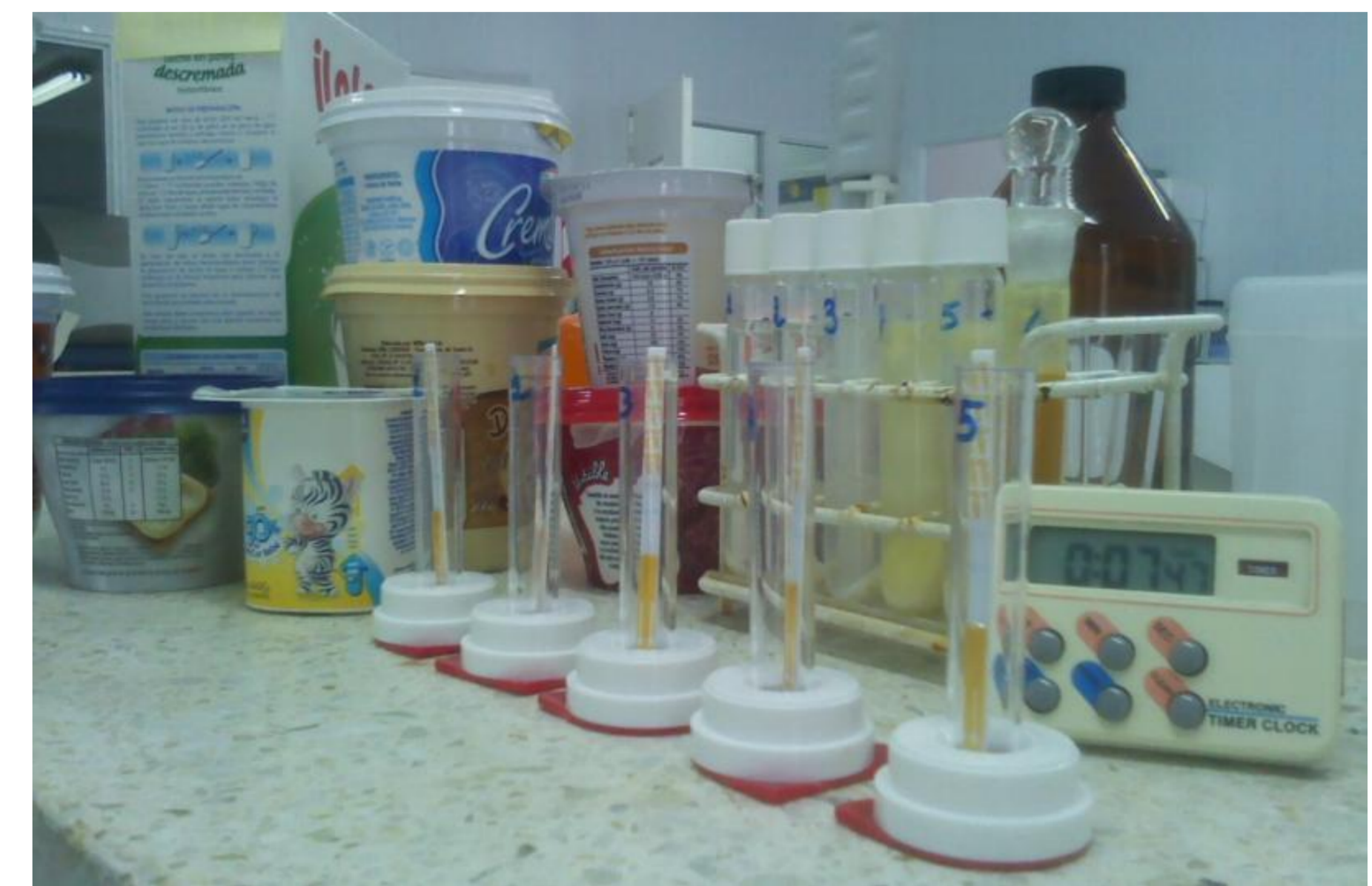
Figura 1: Determinación rápida cualitativa y semi-cuantitativa de gluten de TCC mediante inmunocromatografía de flujo lateral (tiras reactivas)
