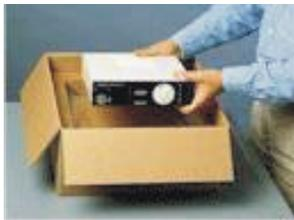
1. En la estación de embalaje, el marco se arma y se coloca dentro de la caja para suspender el producto en el centro del contenedor.
