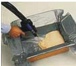
1. La Espuma Instapak® es colocada dentro de la caja que ha sido cubierta con película Instamate®.
