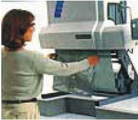
1. Al oprimir un botón el sistema SpeedyPacker™ rápidamente proporciona bolsas llenas de espuma Instapak®.
