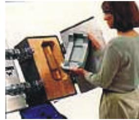
3. Apoyado por un sistema de inyección, el operador retira la bolsa del molde donde se le ha permitido su expansión completa.
