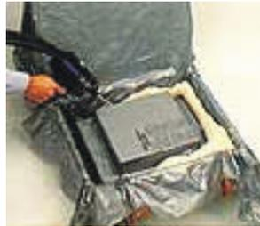
2. Se coloca la película Instamate® en el molde y la espuma Instapak® se inyecta; segundos después se cierra el molde.
