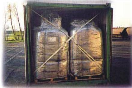
Sistema de trincado de carga de un solo uso.
