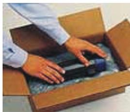
2. La película Instamate® es doblada sobre el Instapak y el producto es colocado sobre la espuma que se ha generado.
