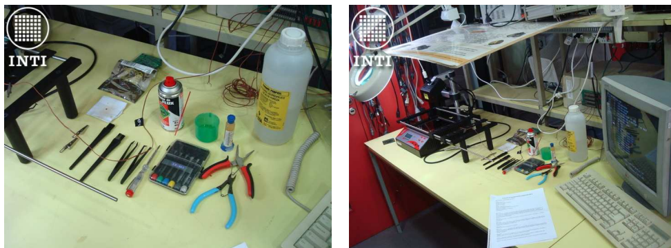
Figura 4: Mesa de trabajo preparada para soldar el BGA.
