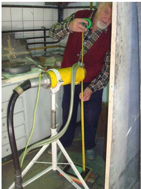
Figura 21: Tubo de rayos X, montaje del dispositivo a radiografiar a 1m de distancia.
