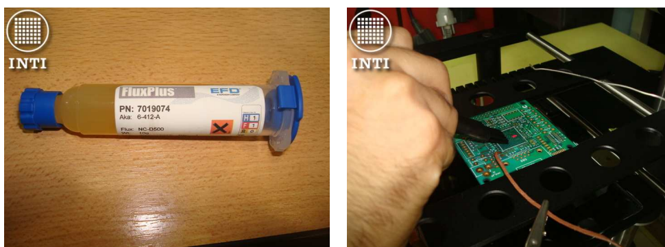
Figura 5: (Izq.) Flux NC utilizado. (Der.) Aplicación con pincel.
