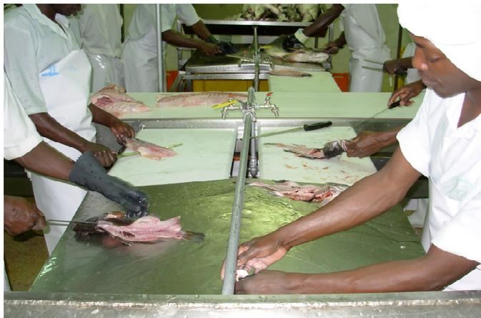
A la mesa debería modificársele la sección para disminuir la posibilidad que material contaminante proveniente de las vísceras “retroceda” hacia el lado en que se produce el filet.
