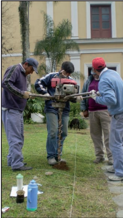
Figura 2. Realizando la perforación con motobarreno (extracción de la muestra F).
