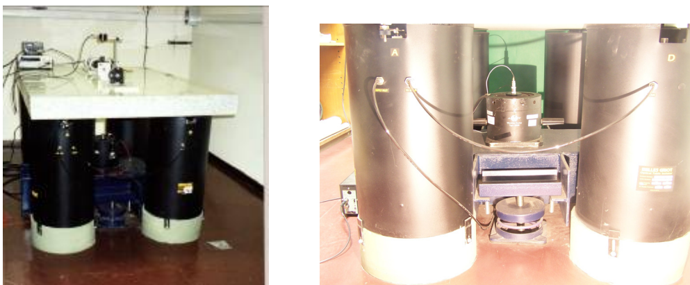
Figura 1 (arriba). Montaje para calibración por interferometría láser de acelerómetros piezoeléctricos en el INTI. Derecha, detalle del montaje del excitador de vibraciones entre las patas de la mesa óptica.
