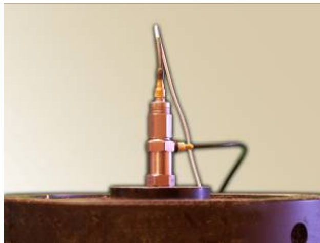
Figura 4. Montaje del calibrando sobre el acelerómetro patrón y ambos sobre el excitador de vibraciones, para el método de calibración secundaria denominado de “ back-to-back ”.
