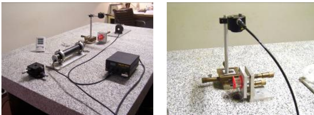
Figura 2. (arriba). Mesa óptica con el interferómetro de plano vertical del INTI y (a la derecha) detalle del cubo separador del haz y orificio para el pasaje del rayo luminoso hacia el segundo espejo, montado sobre el acelerómetro.
