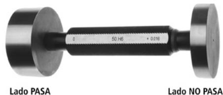
Para mayor claridad analicemos un ejemplo y supongamos que se trata de controlar un agujero  $\varnothing 50 H6$  (50,000; 50,016). El calibre de límites constará de un cilindro cuyo diámetro sea el del límite superior de la tolerancia (50,016) y otro cilindro cuyo diámetro sea el del límite inferior de la tolerancia (50,000).
