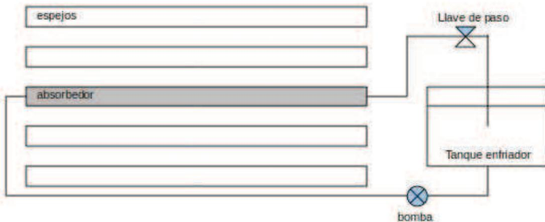
Figura 5.2: Esquema de funcionamiento del equipo con producción de vapor en el absorbedor.
