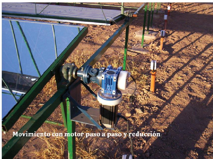
Figura 1.9: Motor paso a paso conectado a un espejo con una reducción de 1/100.
