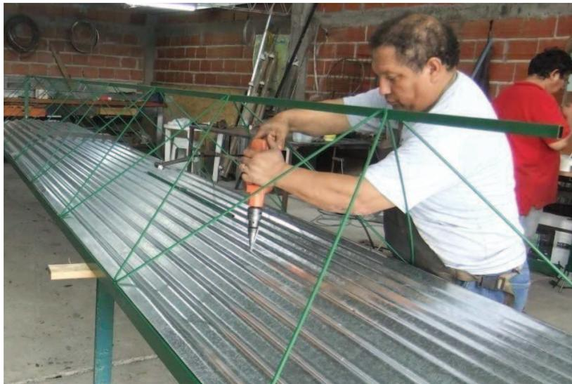
*Figura 1.3: Colocación de la chapa de protección posterior*
