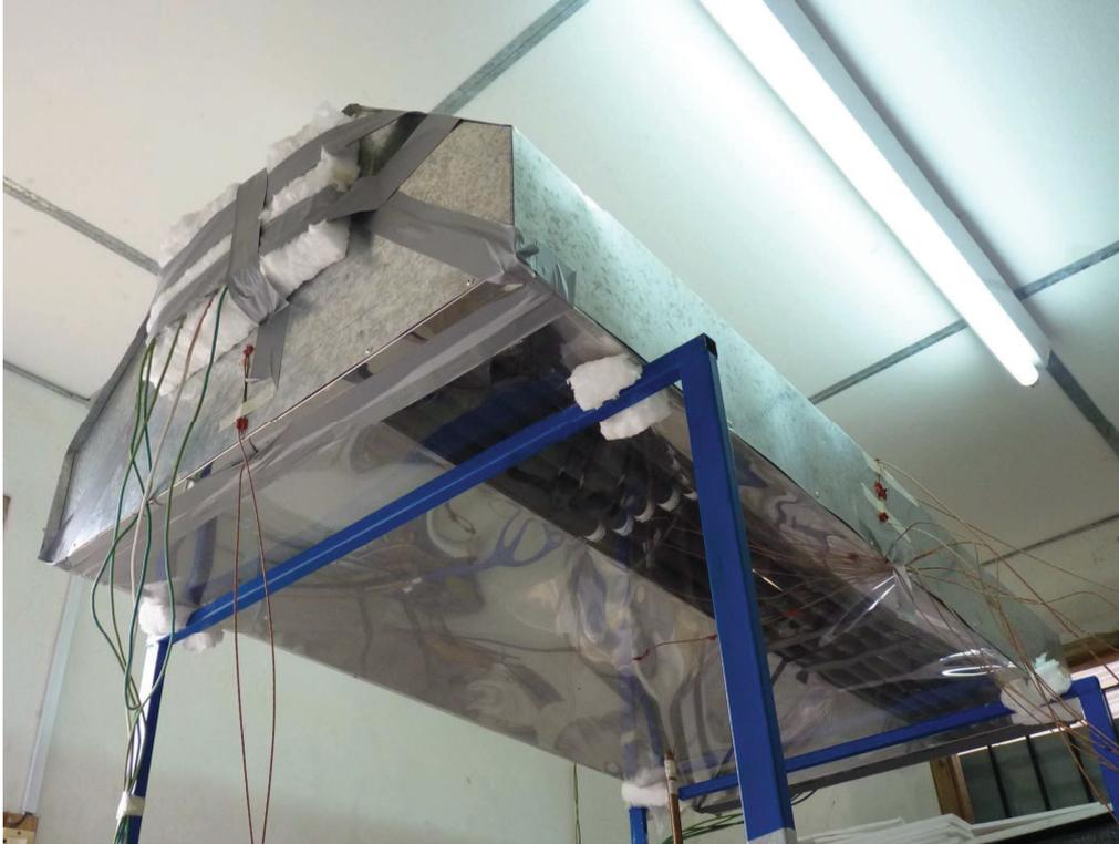
*Figura 2.10: Fotografía del equipo instalado en el laboratorio para simular el comportamiento térmico del absorbedor.*
