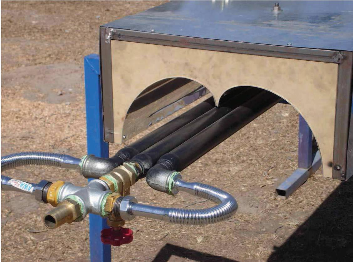
*Figura 1.11: Fotografía del absorbedor de 3 caños instalado en el equipo de 8m<sup>2</sup>*
