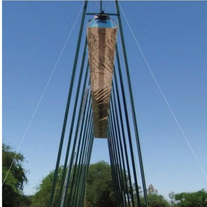
*Figura 1.7: Fotografía del absorbedor trapezoidal con 5 caños colectores*
