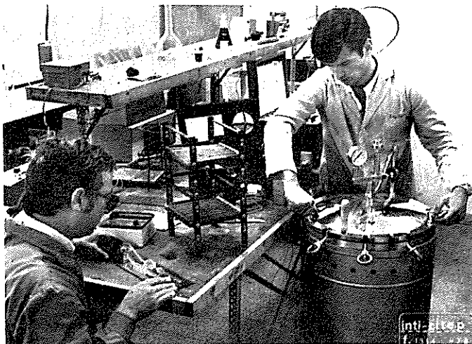
Con un autoclave dos investigadores del CITEP efectúan ensayos de cocción de diversos pescados.
