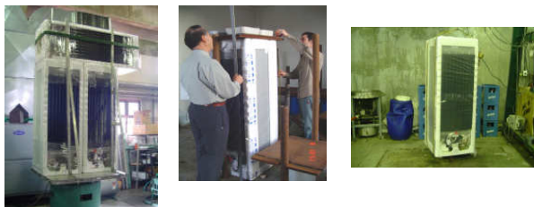
Fig. 6: Ensayos de vibración, apilamiento y caída libre, para evaluar el comportamiento del embalaje.
