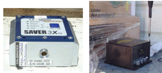
Fig. 1: Equipos de adquisición de datos.
