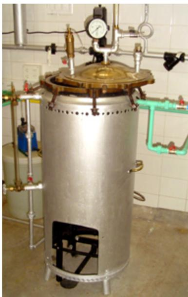
Fig. 1 Autoclave para esterilización de conservas alimenticias en la planta piloto del Centro INTI-Mar del Plata
