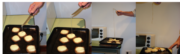
Realización del ensayo de estiramiento en Mozzarella para pizza.
