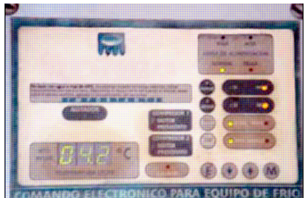
- Termómetro incorporado al equipo de refrigeración para la medición automática de la temperatura de la leche
