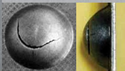
Figura 2. Probetas de acero DP embutidas según ensayo Olsen.
