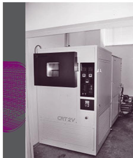
Figura 6. Cámara de choque térmico
