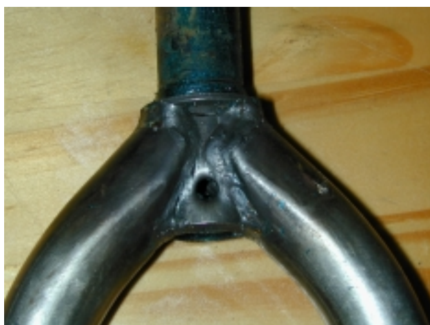
Figura 5. Fisura sobre vela \phi 25,4 \times 2 mm.
