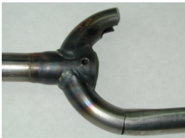
Figura 2. Fractura sobre vaina \phi 25,4 \times 1,2 mm.
