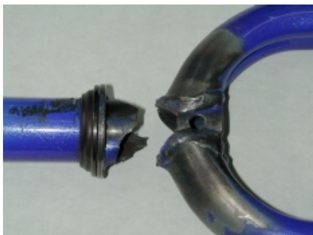
Figura 3. Fractura sobre soldadura en vela \phi 25,4 \times 2 mm
