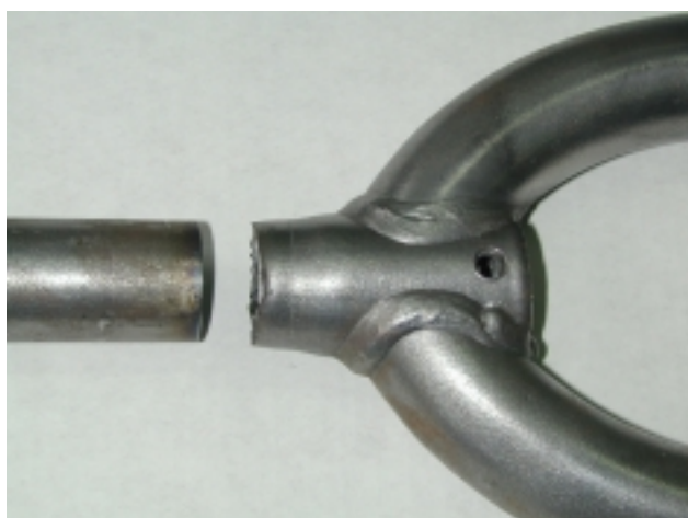
Figura 4. Fractura marca expansión vela \phi 25,4 \times 2 mm.
