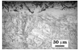
Fig. 2: Micrografía óptica de la sección de una muestra de acero AISI 410 nitrurado por plasma DC-pulsado durante 20 h a 673 K.
