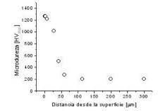
Figura 1. Perfil de microdureza de una acero AISI 410 nitrurado por plasma DC-pulsado durante 20 h a 673 K.
