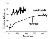
Fig. 3: Coeficiente de fricción versus tiempo de deslizamiento de un acero AISI 410 sin nitrurar y nitrurado por plasma DC-pulsado durante 20 h a 773 K.
