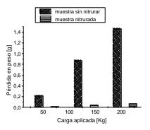
Figura 4. Perdida en peso vs. carga aplicada. Muestras nitruradas y no nitruradas
