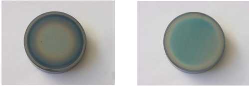
Fig. 1 . Muestras tratadas adiferentes presiones. (a) 2.3 mbar y (b) 5 mbar.
