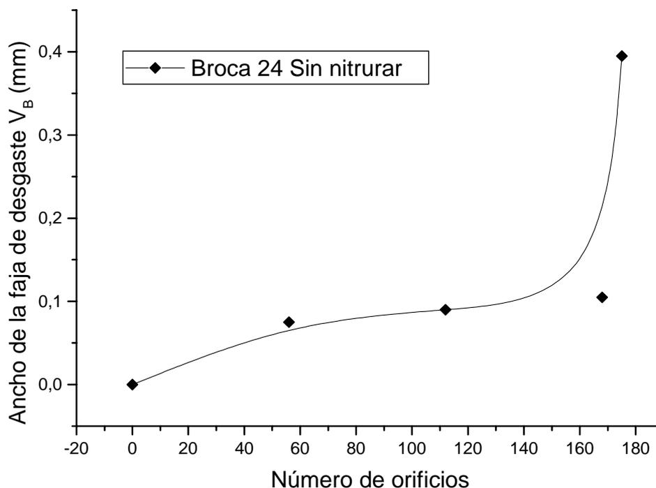
**Figura 2:** Curva típica de evolución del desgaste  $V_B$ , en función de la cantidad de orificios realizados.
