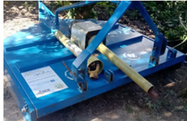
Asociación de Productores de Cândido de Abreu con Anderson Wasilewski para la promoción de buenas prácticas de producción serícola y adquisición de rodalinas mecánicas que permiten la cosecha de hojas de morera de una manera más eficiente, segura y cómoda para el productor. Cândido Abreu, Paraná, Brasil.
