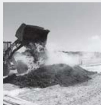
En la ciudad de Mar del Plata, Buenos Aires, funciona una planta municipal de tratamiento de los barros cloacales en la que se aplica la atenuación natural, una metodología anaeróbica. Hasta el 2020 se implementaba en forma alternada con la metodología del compostaje termofílico, proceso aeróbico que utiliza como material estructurante el chip de RP en una relación de 2:1 (lodo/chip). El material producido era utilizado en el vivero municipal.
