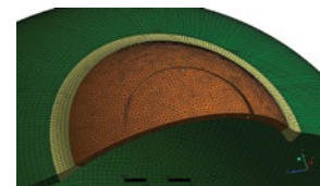
Figura 6: modelo de elementos finitos post ablación.
