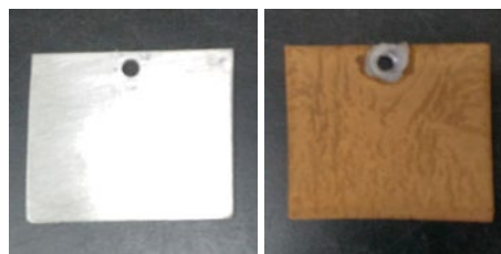
Fotografía 3: Probetas previo y posterior al ensayo
