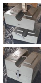
Izquierda-prototipo experimental de 500 kg de capacidad máxima y 0,5 g de resolución .
