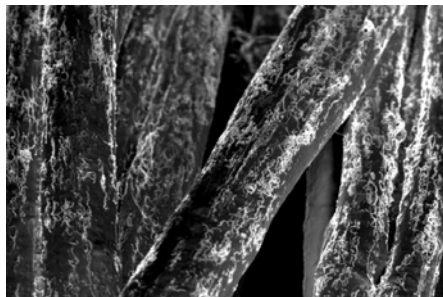
Imagen SEM de fibras de policaprolactona con nanotubos de carbono. La imagen muestra que los nanotubos se encuentran bien distribuidos y alineados dentro de la fibra.
