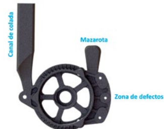
Figura 2: Carcasa, canal de colada y mazarota
