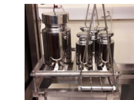
Intercambiador cargado con las pesas a calibrar y los patrones de 10 kg. El malacate se utiliza para cargar la pesa de 50 kg
