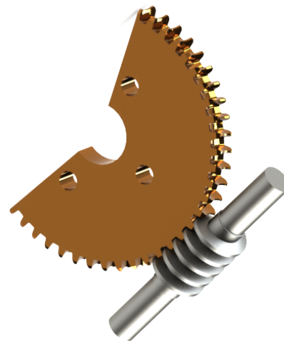
Figura 3: Render de diseño CAD de la rueda helicoidal y tornillo sin fin de la estructura, eje altura solar
