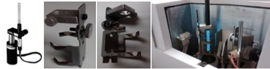
Figura 3. Lámparas espectrales y soporte utilizados para la caracterización de la escala de longitudes de onda.
