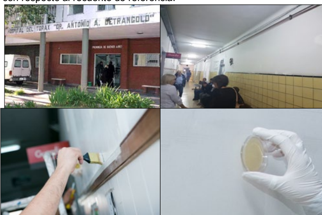
Fig. 1: Áreas críticas del hospital Cetrángolo, aplicación de pintura bactericida y muestreo con placa Rodac.
