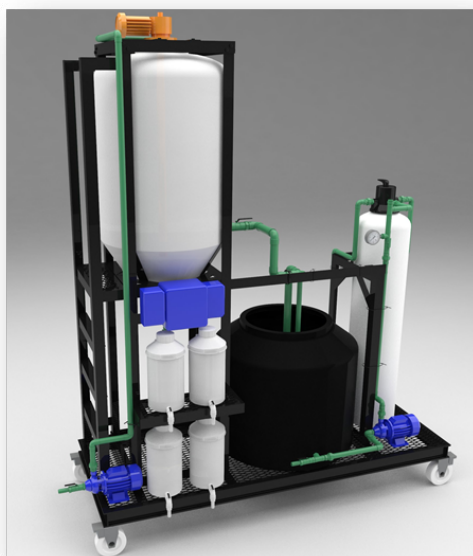
Representación digital 3D del diseño de la planta modular
