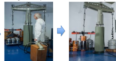
Calibración de una pesa clase F2, en el comparador de brazos iguales de 1000 kg de capacidad
