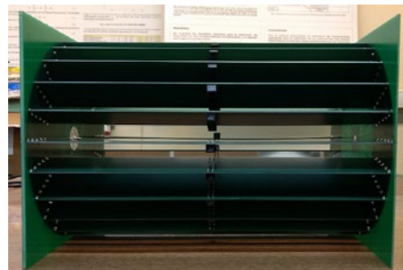
Fig.3 Shunt de corriente alta (50 A y 100 A).
