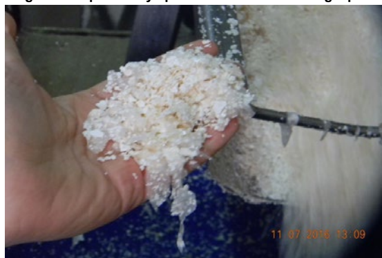
Vista de la cáscara de huevo y de la membrana a la salida del proceso de generación de ovoproductos.
