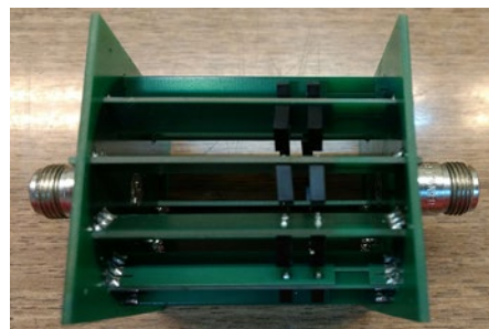
Fig.2 Shunts de corriente media (1 A a 20 A).
