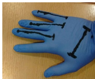
Guante pintado con tinta conductora para registrar la performance del sensor para medir el movimiento de los dedos a partir de la detección de la deformación que producen
