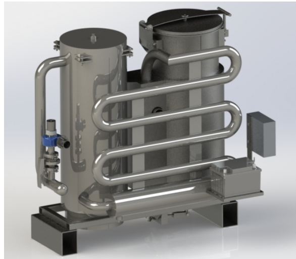
Imagen 1 – Modelo preliminar de 15KW diseñado en SOLIDWORKS
