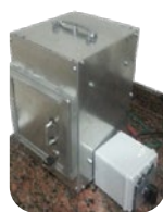
Figura 3: Estufa para secado de probetas a 400^\circ\text{C} .
