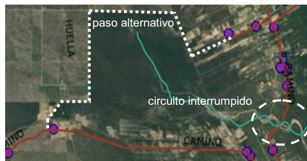
Figura 2. Interrupción en el circuito 1 y paso alternativo.
