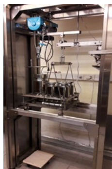
Tercer paso, montaje del patrón de 500 kg clase F1
