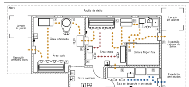
Figura 4. Sala de faena multiespecie escala educativa. Esquema de operaciones y flujo de productos.
