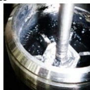
Proceso de molienda húmeda de pigmento conductor.
