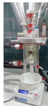
Figura 2: Reactor encamisado de 500 mL utilizado para la síntesis de ImpC de Carvedilol.
