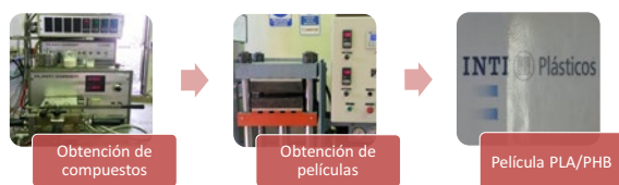
Figura 1. Obtención de compuestos de PLA/PHB plastificados con PPG por mezclado en fundido.
