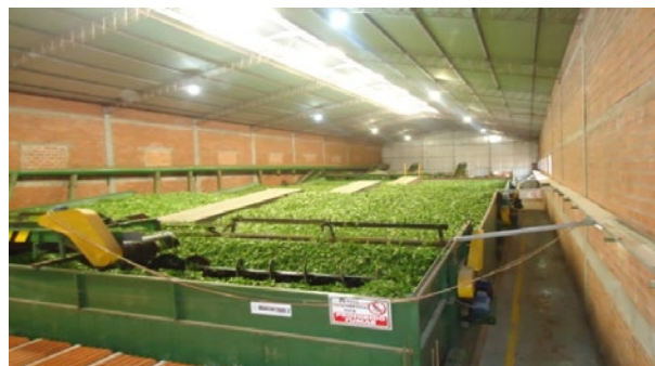
Figura 2. Mejoras edilicias realizadas, luces con protecciones, cierre de ventanas abiertas que comunicaban la planta con el exterior.
