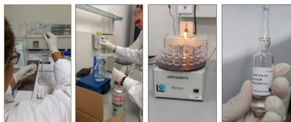
Proceso de elaboración de soluciones calibrantes y envasado en ampollas.
