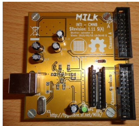
Milk: placa de configuración y comunicación con Kéfir I
