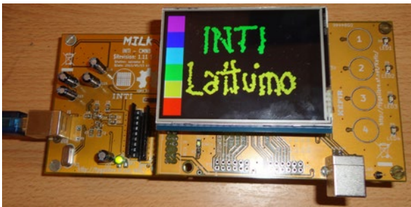
Lattuino: Kéfir I configurada como un Arduino con shield de pantalla táctil
