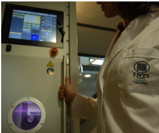
Figura 2: Equipo de plasma a escala laboratorio en INTI -Textiles. (figura 2), de baja frecuencia y con presiones de 0.30-0.50 mBar.
