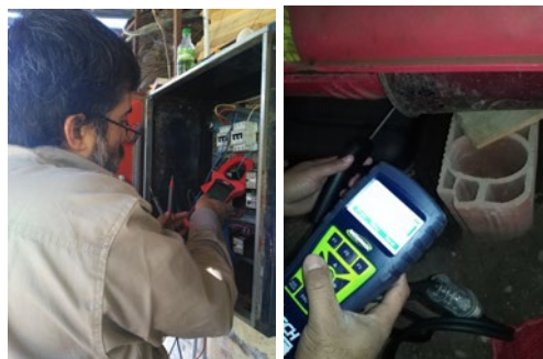
Figura 2: Medición de consumo eléctrico y gases de combustión.
