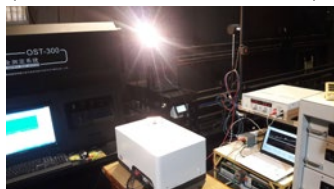
Espectroradiómetro Everfine OST300, con el control de parámetros eléctricos de la fuente de irradiancia.
