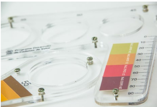
Figura 2. Diseño Calibres para clasificación por tamaño y maduración
