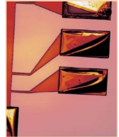
El metal se depositó por evaporación asistida por electrones (Ni) y por evaporación Joule (AuGe) en una misma campana.
