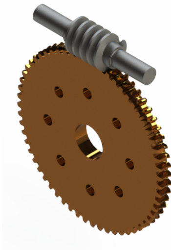
Figura 2: Render de diseño CAD de la rueda helicoidal y tornillo sin fin de la estructura, eje acimut
