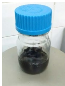
Preparación de la tinta de nanotubos de carbono para pintar los sustratos de caucho nitrilo.
