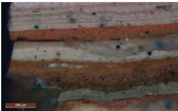
Figura 1: Microfotografía de un fragmento donde pueden observarse parte de la disposición estratigráfica de las más de 20 capas de pintura que componen la muestra tomada de la fachada de un edificio histórico.
