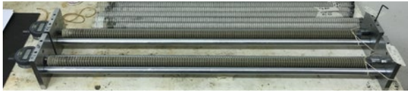
Dilatómetros con los tubos sellados en la posición de lectura
