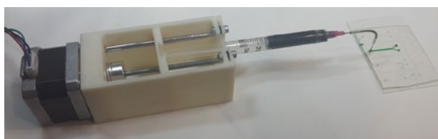
Foto del prototipo microfluídico con sistema de inyección
