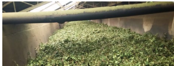
Figura 1. Hojas de yerba secando dentro de un secadero a cinta
