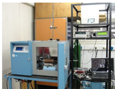
Generador con SPRT adicional y Sub-cámara de cobre.
