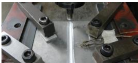
Fig. 1. Equipo para soldar por fricción-agitación y adquirir ciclos térmicos
