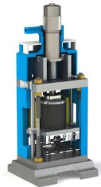
Diseño 3D de Prensa de tornillo didáctica.
