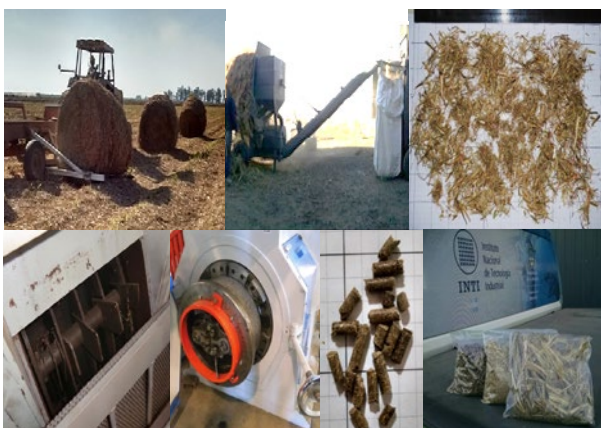
1-Rollo en Campo. 2-Desmenzadora. 3-RAC luego del Desmenzado. 4-Molino de Martillos. 5-Prensa Pelletizadora 6-Pellets de RAC 7-Transformaciones de la Biomasa
