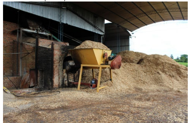
Imagen 2: Modelo de quemador de chip de leña utilizado en la industria.
