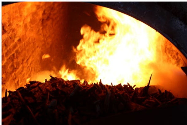
Imagen 1: Combustión de chip de leña en quemadores utilizados para el proceso de secado de la yerba mate.
