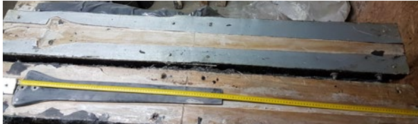
Figura 1: Aspa de fibra de vidrio y resina epoxi de aerogenerador de baja potencia "cortada", sobre la matriz de longitud completa.
