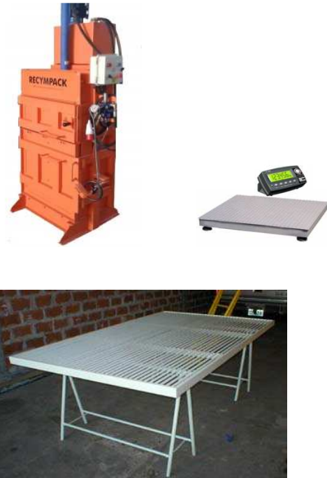
Fig. 2: Elementos a incorporar: enfardadora para papel, cartón y plásticos; balanza electrónica; mesa de clasificación
