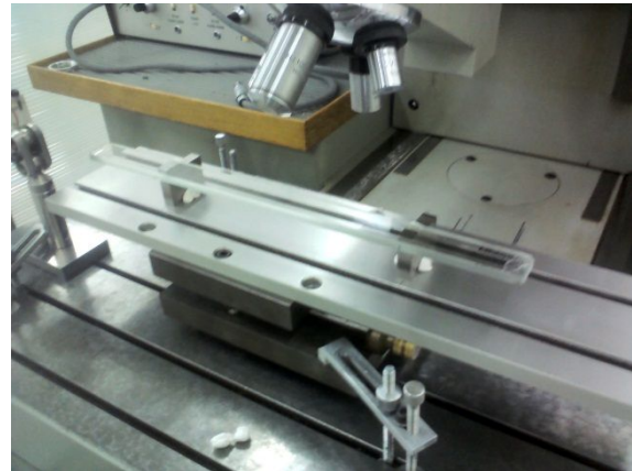
Figura 2: montaje de escala lineal en carro de máquina de medir en tres coordenadas
