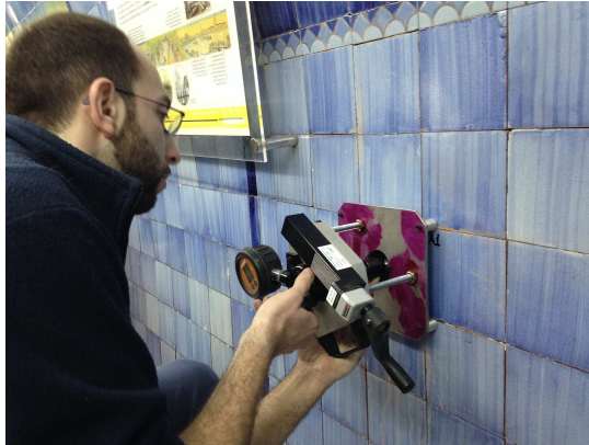
Figura 3: Ensayo de adherencia por tracción simple mediante equipo descrito en lineamientos de la norma IRAM 1764.
