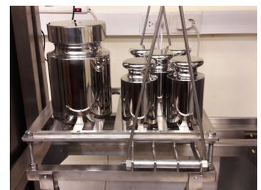
*Intercambiador cargado con la pesa a calibrar y los patrones de 10 kg. El malacate se utiliza para cargar la pesa de 50 kg*
