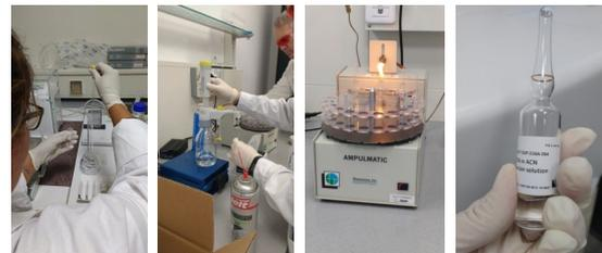
Figura 1: Proceso de elaboración de solución calibrante y envasado en ampollas.
