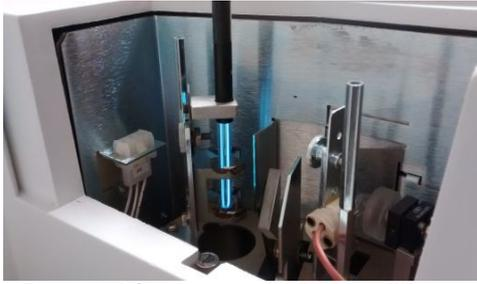
Figura 3: Lámpara espectrales pencil lamp.
