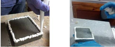
Figura 3 y 4: Aplicación del sellador en el surco perimetral (izq) y rociado del CLFMC (der)
