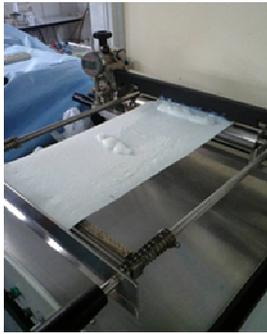
Figura 2: Racla para recubrimientos textiles
