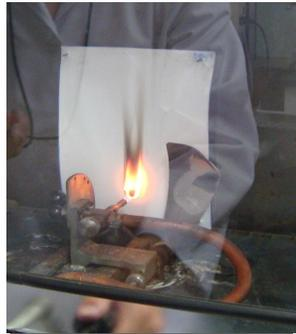
Figura 3: Ensayo de Propagación a la Llama
