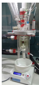
Esquema 2: Síntesis de ImpC de Carvedilol. Figura 2: Reactor encamisado de 500 mL utilizado para la síntesis de ImpC de Carvedilol.
