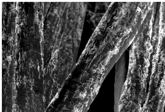
Figura 2. Disposición de los nanotubos de carbono dentro de la fibra. Se observa una alineación de los mismos a lo largo de la fibra.
