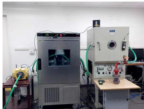
Figura 1: medidores sometidos a ensayos de temperatura
