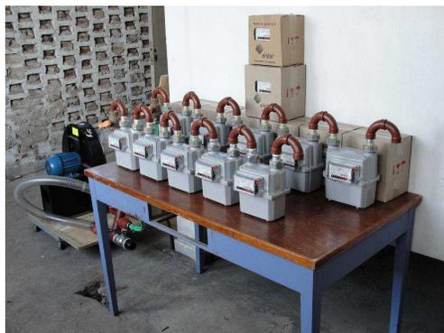
Figura 2: Línea de trabajo para ensayos de funcionamiento prolongado.
