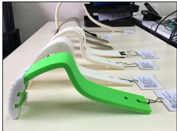
Figura 1: Prótesis impresas por FDM en ABS y fibra de vidrio
