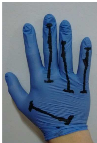
Figura 1. Guante de caucho nitrilo pintado con tinta de NTC.
