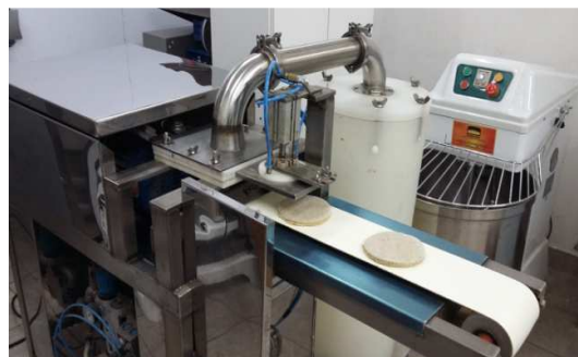
Figura 3: Embutidora y formadora para la obtención de las hamburguesas.
