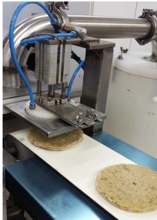
Figura 2: Cabezal neumático formador para la obtención de las hamburguesas
