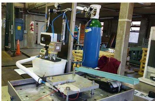
Figura 4: Ensayo de vibración para aprobación de modelo en INTI- Envases y Embalajes.
