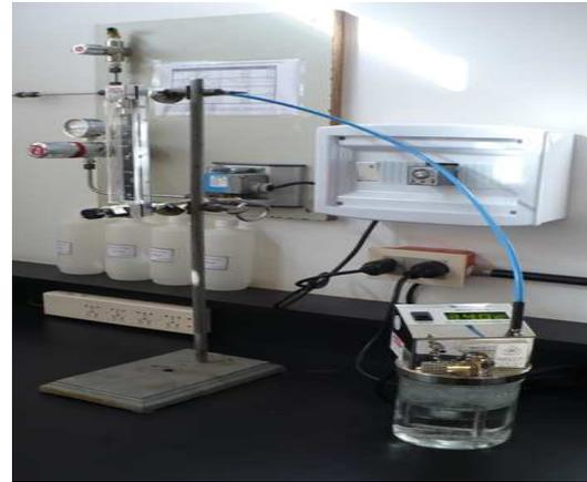
Figura 1: Primer banco de calibración de alcoholímetros.
