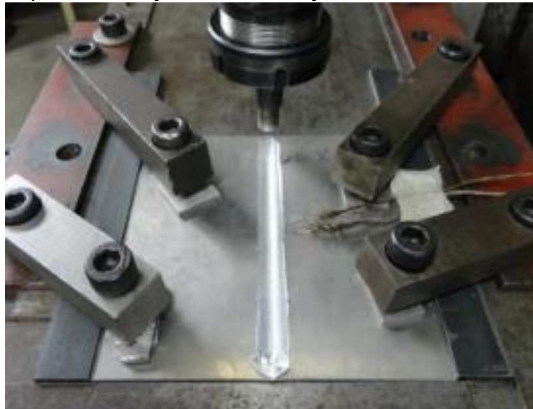
Figura 1: Montaje de las chapas a soldar y dispositivo.
