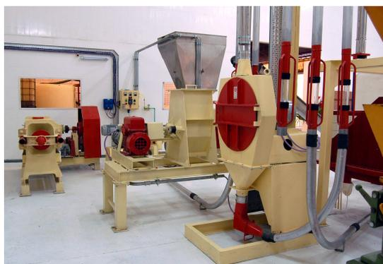
**Figura 1: planta piloto de extrusión – prensado de INTI Cereales y Oleaginosas.**
