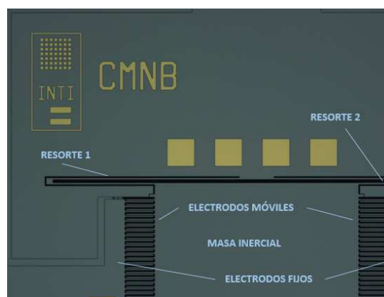
Figura 1: Imagen de microscopio óptico del diseño 'A'. Se observa una parte de la estructura.
