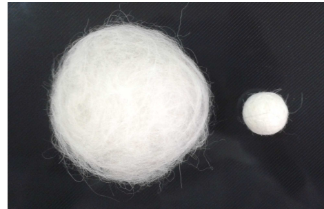
Figura 2: Método para medir la tendencia al afieltrado. Izq. preparación del espécimen de ensayo, der. muestra ensayada.
