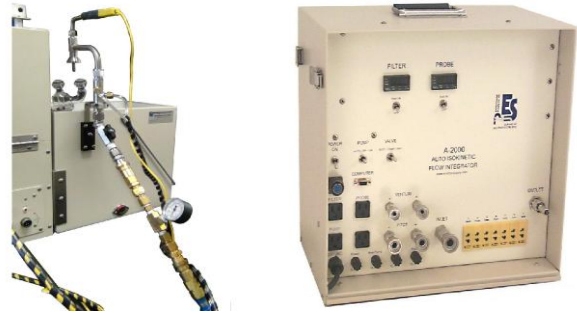
Imagen 3: Equipo de Muestreo isocinético A-2000
