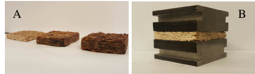
Figura 1: A) Probetas antes y después de ser sometidas al ensayo de hinchamiento, B) Probetas para el ensayo de Resistencia a la tracción perpendicular.
